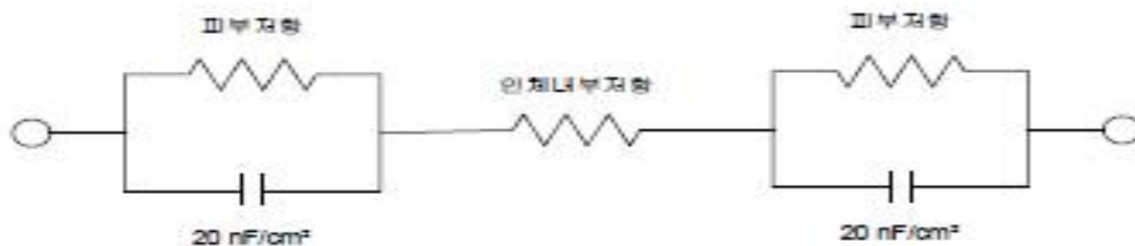
<그림 1> 인체 임피던스 모형도
